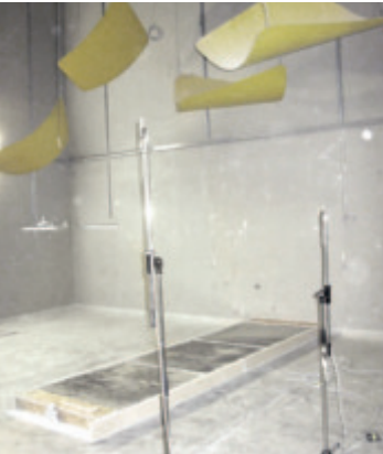
Versuchsaufbau mit drei AIRCONOMY® Systemmodulen im Fraunhofer-Institut
