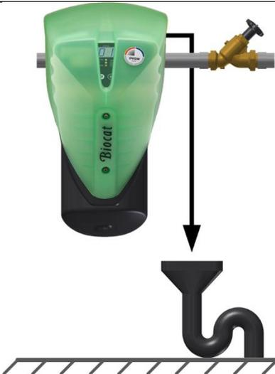
Rückpulleitung direkt in Abfluss.
