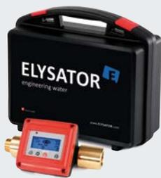
In Transportkoffer mit passgenauer Schaumstoffeinlage zum Schutz des Messzählers sowie extra Fach für z.B. Leitfähigkeit oder pH Messgerät.
