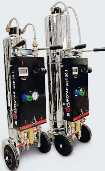
Die PUROTAP® 25.1/50.1 Füllstationen bereiten Wasser für die technische Anwendung in geschlossenen Systemen gemäß den gültigen Normen (VDI 203 / Ö-Norm H5195) auf. Der neue Partikel und Magnetfluss-Filter reinigt das Wasser von Schwebstoffteilen und das Mischbettharz demineralisiert das Wasser.
