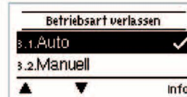
Im Menü "3. Betriebsart" kann der Regler neben dem Automatikbetrieb auch ausgeschaltet oder in einen manuellen Betriebsmodus versetzt werden.
