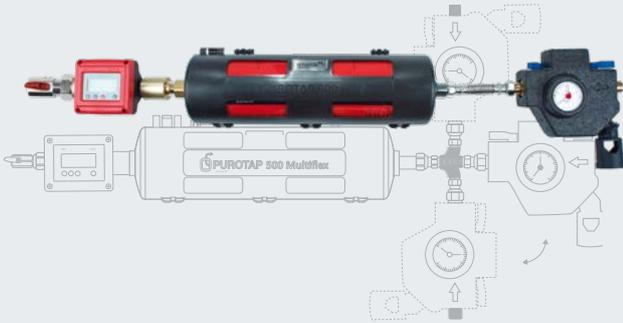
Automatische Nachspeiseeinrichtung für Heizungsanlagen. Für den variablen Festeinbau, mittels flexiblen Edelstahlwellrohr. Inkl. Systemtrenner BA sowie LFM Messgerät zur Kontrolle der Leitfähigkeit und Messung von Kapazität der Einwegpatrone sowie Menge vom Nachspeisewasser.
