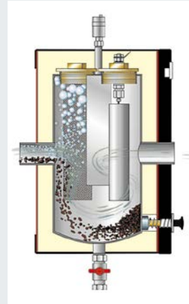
Installation und eine halb verbrauchte Schutzanode, welche in kleineren und mittleren Heizungsanlagen für zuverlässigen Korrosionsschutz sorgt. (Abb: Elysator)
